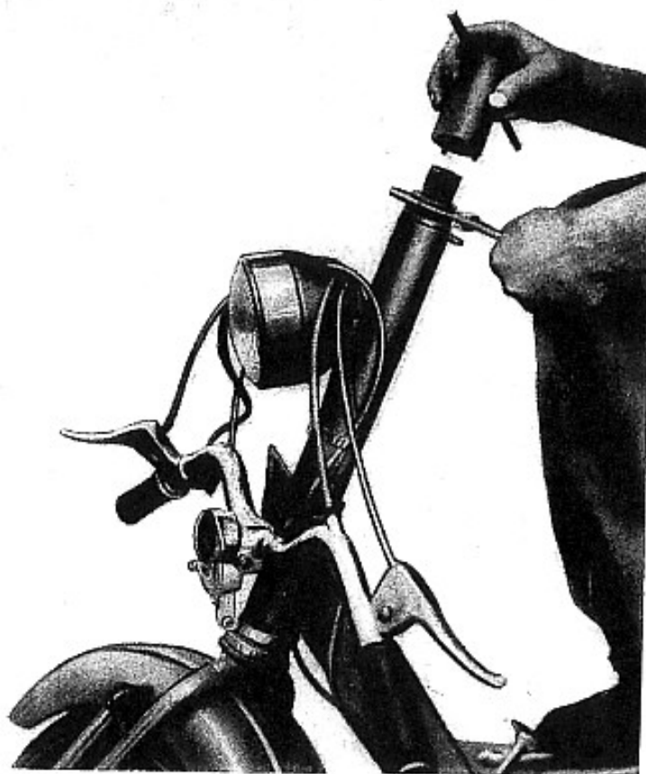
Fig. 42 - Smontaggio ghiera cuscinetto superiore sterzo.
